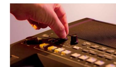
Les deux boutons LIVE CONTROL peuvent être assignés afin de contrôler divers paramètres
