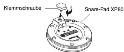
3. Bringen Sie das Snare-Pad XP80 an der Stange an, und ziehen Sie dann die Klemmschraube fest, um das Snare-Pad zu befestigen.
