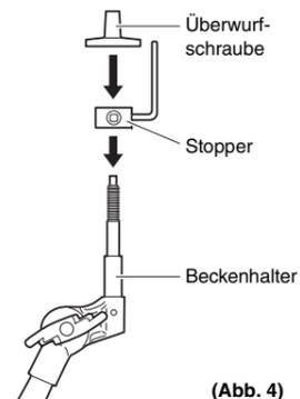
6. Platzieren Sie den Stopper so, dass vollständiger Kontakt mit der Unterseite der Überwurfschraube hergestellt ist, und ziehen Sie den Keilbolzen mit einem Stimmschlüssel fest, um den Stopper zu fixieren (Abb. 5).
