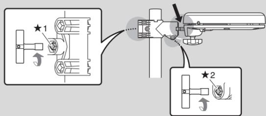
4. Justieren Sie den Winkel des Snare-Pads, indem Sie zunächst den Keilbolzen (★1 und ★2 in der vorstehenden Abbildung) lösen. Ziehen Sie den Keilbolzen nach dem Justieren wieder fest.
