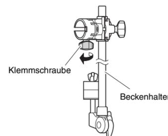
3. Schieben Sie die Halteklemme auf das TOM3-Rohr und ziehen Sie die Klemmschraube des Beckenhalters leicht an.
