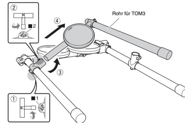
2. Lösen Sie die Klemmschraube des Beckenhalters.
