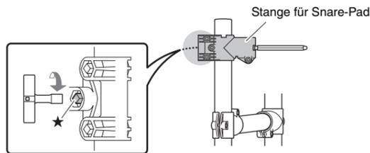
2. Schrauben Sie die Klemmschraube in die Fassung am Snare-Pad. (Drehen Sie die Klemmschraube fünf bis sechs Mal.)
