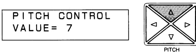
**Taste  $\Delta$ :** Bei jedem Tastendruck wird die Tonhöhe leicht angehoben. (Wenn  $A_3=440$  Hz, entspricht 1 Schritt etwa 0,3 Hz über einen Maximalbereich von 15 Schritten.)
