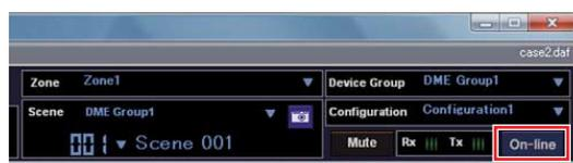
**5-4** Wenn das Synchronization-Fenster angezeigt wird, wird der Text „Select IP Address“ (IP-Adresse wählen) in Rot angezeigt. Klicken Sie auf diese Meldung und wählen Sie in der Dropdown-Liste die erforderliche IP-Adresse aus.
