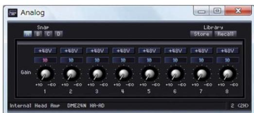
Per Grundeinstellung ist Gain (Verstärkung) auf +10 dBu eingestellt (die geringstmögliche Verstärkung).
