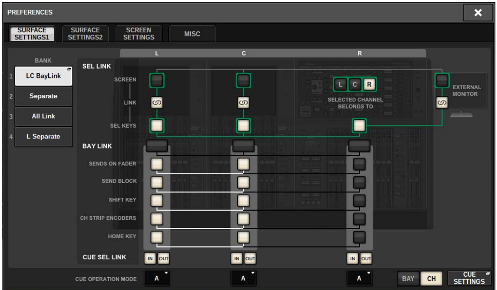
LC BayLink... Bay L und Bay C können verkoppelt und wie eine Bank mit 24 Fadern verwendet werden.
