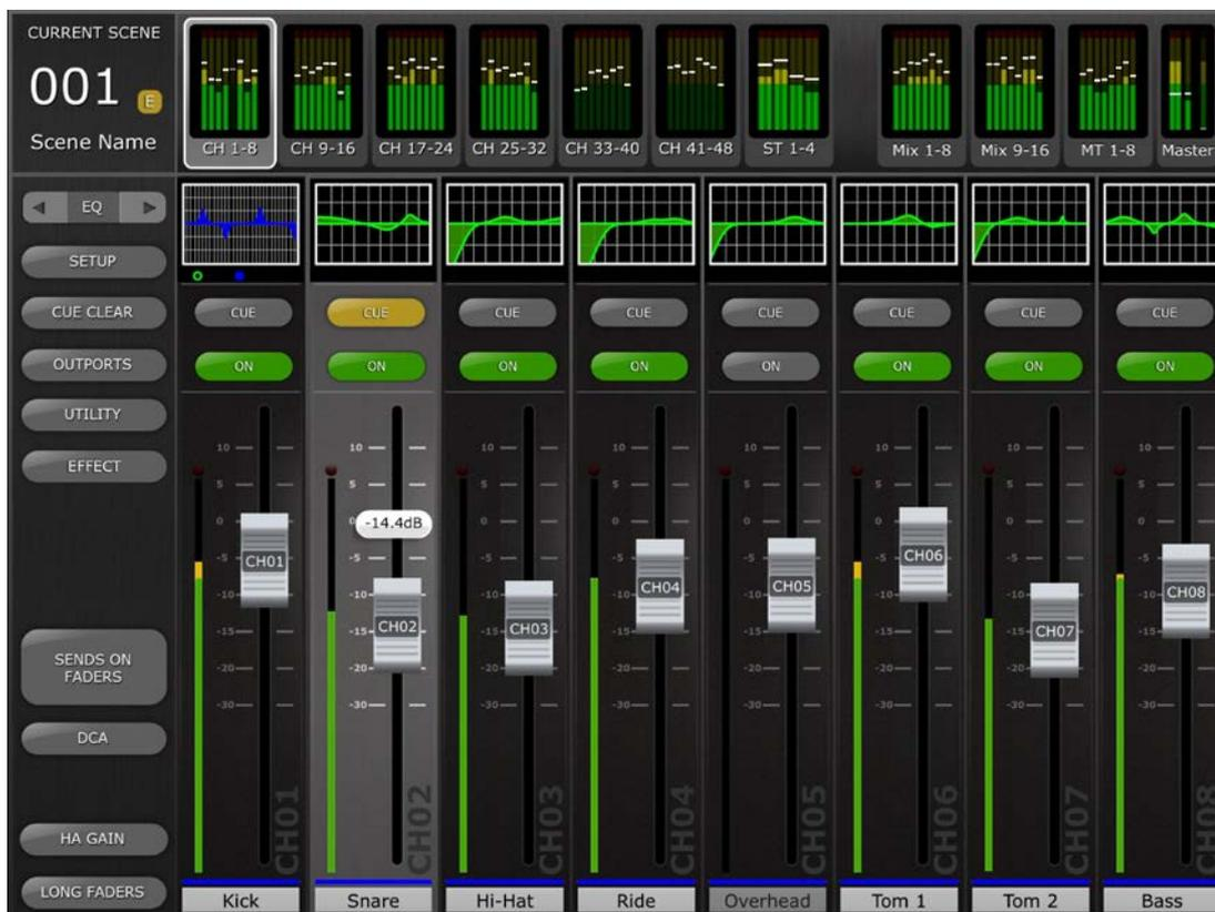
Entlang des oberen Bildschirmrandes werden die Pegelanzeigen und Schieberegler der Mono-Eingangskanäle 1–48, der Stereo-Eingangskanäle 1–4, der Mix- und Matrix-Busse sowie der Master-Stereo- und -Mono-Busse in Kanalblöcken angezeigt. Dies ist die „Navigation/Meter Bridge“.
