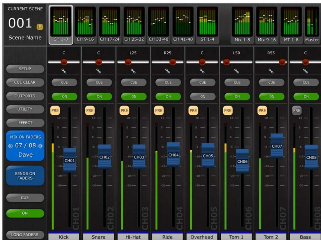
Die große Taste [MIX ON FADERS] zeigt die Nummer des momentan ausgewählten Mix- oder Matrix-Busses sowie dessen Namen an. Die Farbe dieser Taste stimmt mit den Farben im M7CL-Pult überein.
