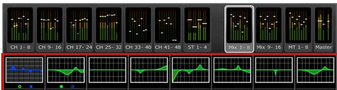
Grüne und blaue Punkte unterhalb jeder EQ-Kurve zeigen an, welche Art(en) von EQ bei dem Kanal verfügbar sind, sowie die Art des EQ (PEQ oder GEQ), die für diesen Kanal aktuell angezeigt wird. Ein grüner Punkt zeigt einen PEQ an; ein blauer Punkt einen GEQ. Wenn bei einem Kanal momentan nur der PEQ verfügbar ist, erscheinen keine Punkte unterhalb der Kurve. (Im Demo-Modus erscheinen GEQs bei den Mix-Bussen 1, 7, 8 und Mono).
