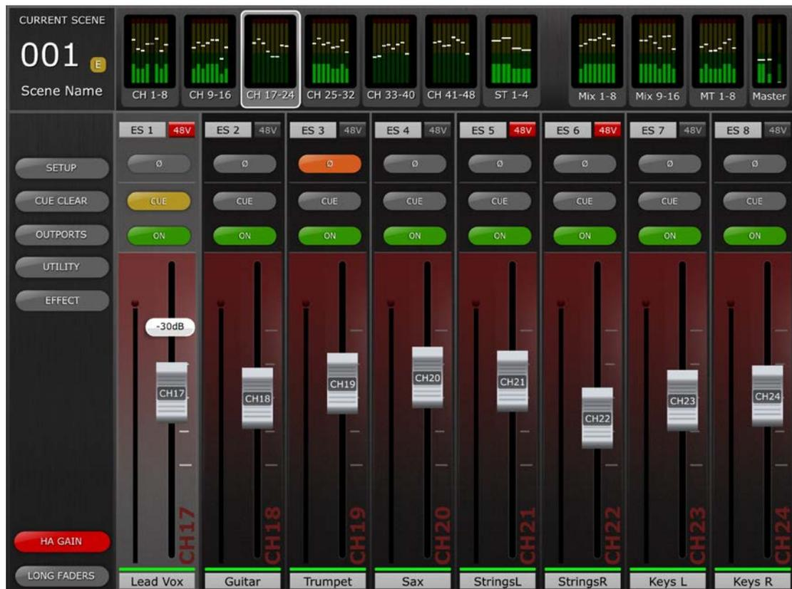
Die Schieberegler können bewegt werden, um den HA Gain für jeden Kanal zu ändern. Der Gain-Wert jedes Eingangsverstärkers wird oberhalb der Schieberegler angezeigt, sobald das Bedienelement des Schiebereglers berührt wird. Bis zu 8 Schieberegler können gleichzeitig eingestellt werden.
