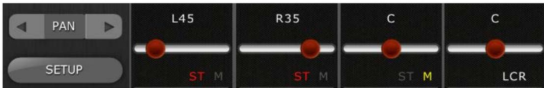
Durch Text wird angezeigt, ob die einzelnen Kanälen den ST-, Mono- oder LCR-Bussen zugewiesen sind.
