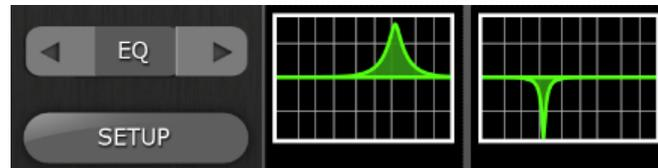
Die Tasten links neben den Piktogrammen werden verwendet, um durch Tippen auf die Links- oder Rechtspfeiltaste zwischen EQ, PAN- und Dynamics-Modus zu wählen.
