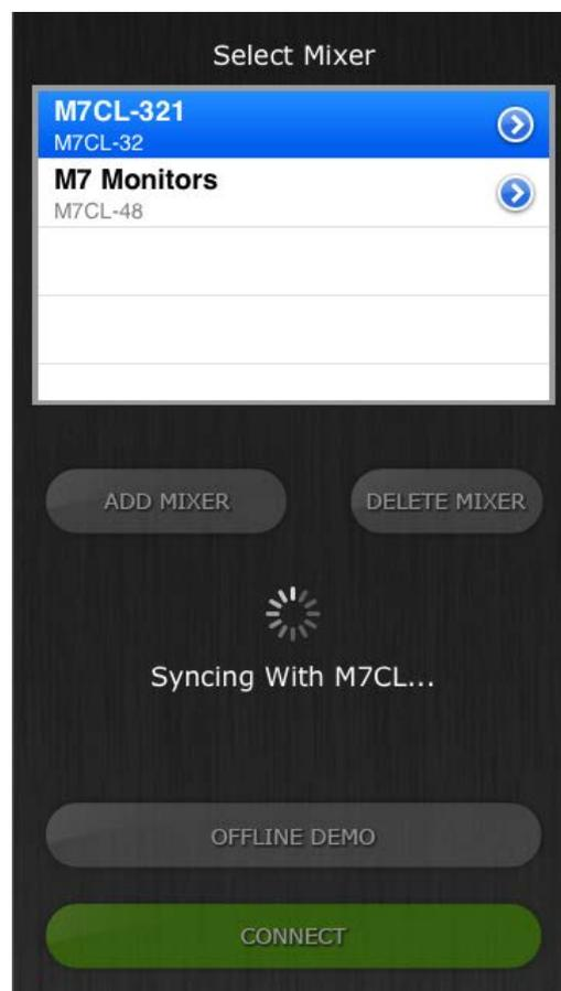
Die Meldung „Syncing With M7CL...“ (Synchronisieren mit dem M7CL) erscheint, während StageMix Parameter vom Pult abfragt. Nachdem dieser Prozess beendet ist, erscheint das Mixer-Fenster, und StageMix kann bedient werden.
