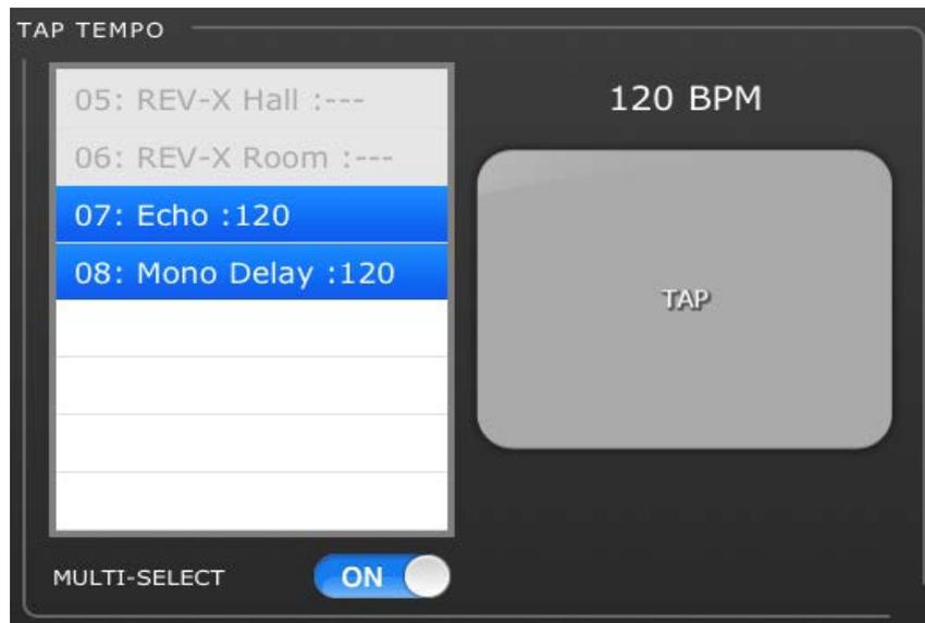
Wählen Sie den entsprechenden Effekt aus der Liste der 4 Effekte an der linken Seite dieses Bereichs aus. Effekte ohne BPM-Parameter sind ausgegraut und lassen sich nicht auswählen.
