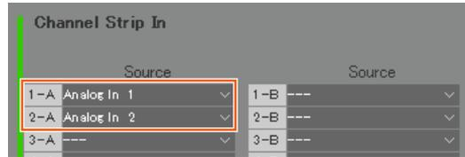
Asigne las entradas Analog In 1 y 2 conectadas a la salida del preamplificador de micrófono a las entradas Channel Strip In 1-A y 2-A, respectivamente.
