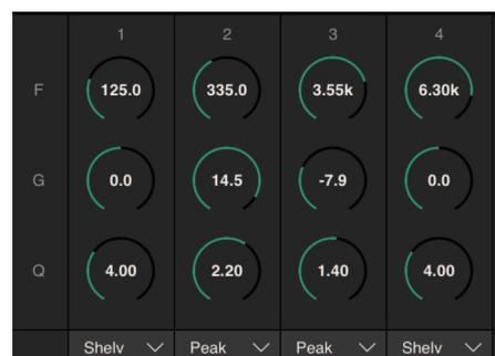
Arrastre para cambiar los parámetros del ecualizador de cuatro bandas (frecuencia, ganancia, Q). Pulse dos veces para recuperar los valores predeterminados de estos parámetros (F: 125 Hz/355 Hz/3,55 kHz/6,3 kHz, G: 0 dB, Q: 4,0 (Shelf)/1,4 (Peak)/1,0 (Notch)). También puede seleccionar el tipo de ecualizador en Peak y Shelf (Shelving) o Peak y Notch.
