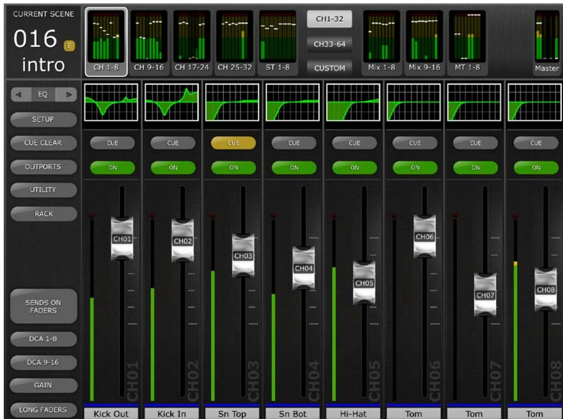
Entlang des oberen Bildschirmrandes werden die Pegelanzeigen und Schieberegler der Mono-Eingangskanäle 1–32, der Stereo-Eingangskanäle 1–8, der Mix- und Matrix-Busse sowie der Master-Stereo- und -Mono-Busse in Kanalblöcken angezeigt. Dies ist die „Navigation/Meter Bridge“.
