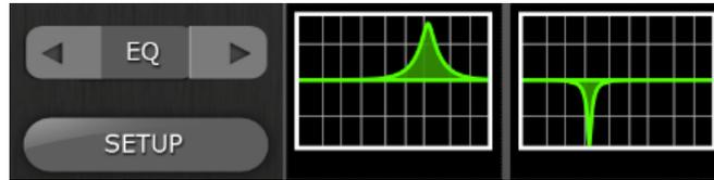
Mit den Tasten links der Miniaturansicht können Sie durch Antippen der linken und rechten Cursortasten zwischen EQ-, PAN-, 5.1-, Dynamik- und Sends-Modus umschalten.
