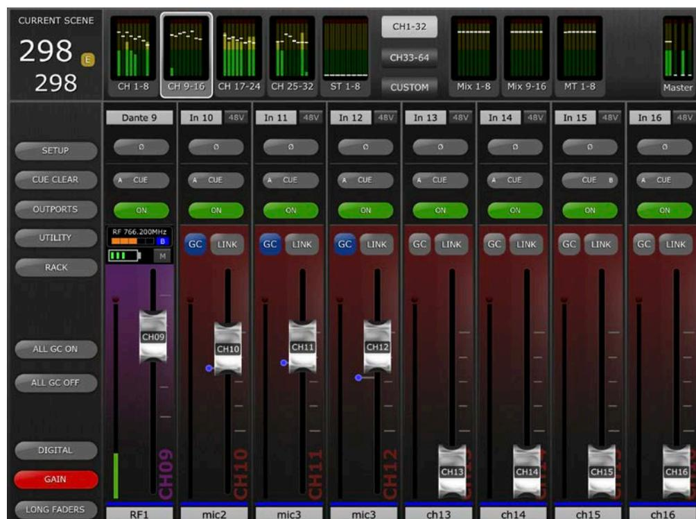
Der Fader steuert die Ausgangsverstärkung des Empfangskanals (RX). Über dem Fader wird der aktuelle Batterieladezustand des kabellosen Mikrofons angezeigt. Rechts der Batterieanzeige wird der Stummschaltungsstatus des Audioausgangs des Empfängers angezeigt (falls am Empfänger verfügbar). Tippen Sie hierauf, um das Audiosignal des Empfängers stummzuschalten bzw. die Stummschaltung aufzuheben – zur Bestätigung erscheint ein Einblendfenster.
