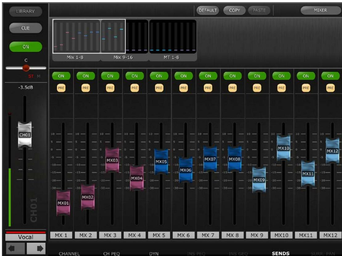
Verwenden Sie die Meter Bridge, um horizontal zu wischen und Mix/Matrix Sends mit höherer bzw. niedrigerer Nummer anzuzeigen.
