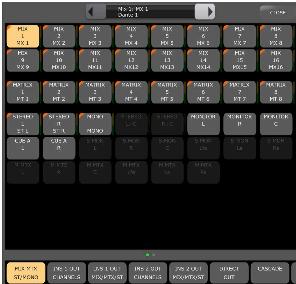
Auf jeder Schaltfläche des Rasters werden Nummer, Namen und Typ der Ausgangskanäle dargestellt. Wenn dem Kanal ein Name zugewiesen wurde, wird dieser auch mit der Kanalfarbe dargestellt, falls gewählt. Bei Mix/MT/Mono/ST-Ausgangsbuss-Gruppen wird der Ausgangspegel links von jeder Schaltfläche dargestellt.
