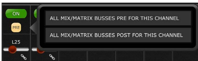
Wenn der aktuelle Kanal ein Mix-Ausgangskanal ist, werden nur die Sends zur Matrix angezeigt.
