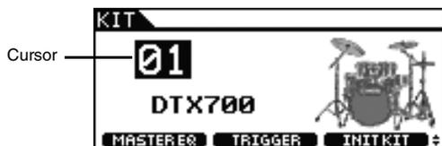
Durch Drehen des Datenrads in einer der beiden Richtungen können Sie den Wert an der aktuellen Cursor-Position ändern.
