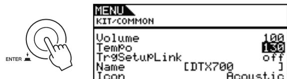
In diesem Zustand können Sie den mit dem Cursor ausgewählten Wert ändern, indem Sie das Datenrad drehen.
