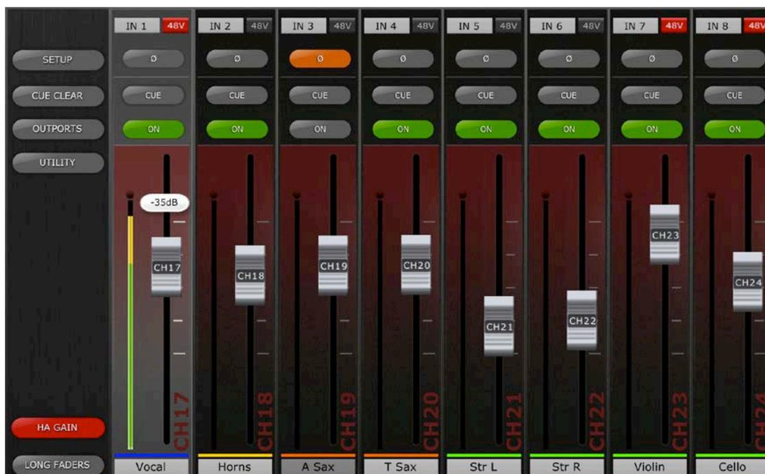
Die Schieberegler können bewegt werden, um den HA Gain für jeden Kanal zu ändern. Der Gain-Wert jedes Eingangsverstärkers wird oberhalb der Schieberegler angezeigt, sobald das Bedienelement des Schiebereglers berührt wird. Bis zu 8 Schieberegler können gleichzeitig eingestellt werden.
