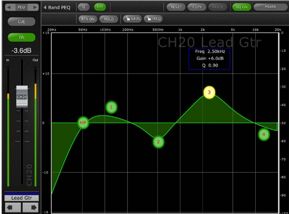
Name, Farbe, Schieberegler, Pegelanzeigen, [ON]- und [CUE]-Tasten des Kanals werden in der linken Spalte angezeigt. Unten links finden Sie Pfeiltasten, mit denen Sie den jeweils vorigen und nächsten Kanal erreichen können.
