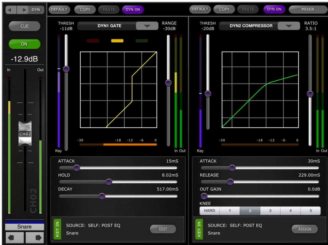
Die linke Seite dieses Bildschirms (der Kanalzug) ist identisch mit dem Bildschirm zur EQ-Bearbeitung, mit Kanalfader, On-Schaltfläche, Cue-Schaltfläche, Ein- und Ausgangspegelanzeigen, Kanalnamen, Farb- und Navigationsschaltflächen.
