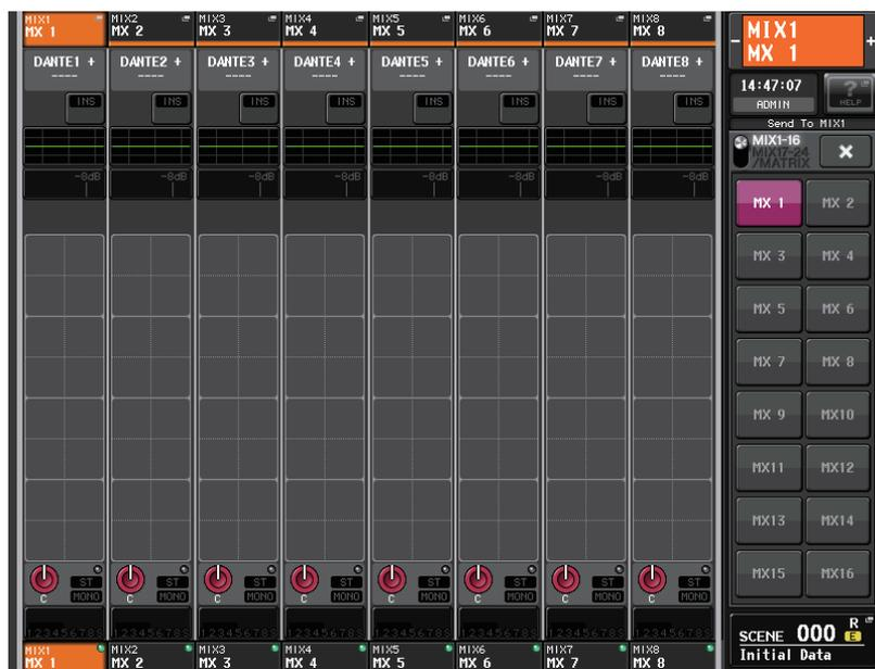
3. MIX1-16、MIX17-24/MATRIX の切り替えボタンを押して、MIX1-16 または MIX17-24/MATRIX に切り替えます。
