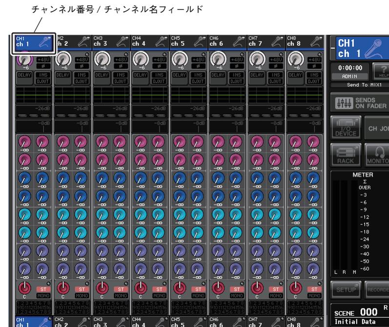
2. チャンネル名/アイコン/チャンネルカラーを設定したいチャンネルのチャンネル番号/チャンネル名フィールドを押して、PATCH/NAME ポップアップ画面を表示させます。
