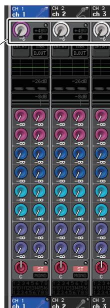
9. 外部 HA を操作したいチャンネルの GAIN/PATCH フィールドを押して、GAIN/PATCH ポップアップ画面を表示させます。
