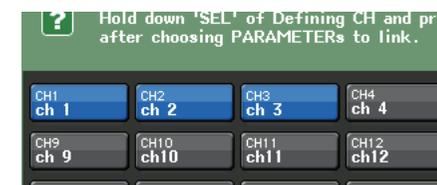
7. リンクを確定させるには、画面左下の LINK ボタンを押します。
