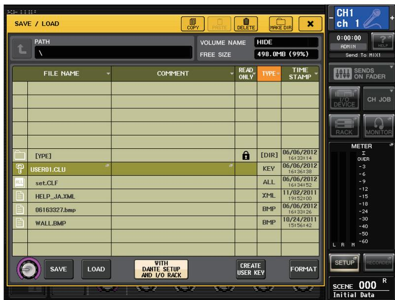
4. ファイルリストに表示されたヘルプファイルを押す、またはパネル上のマルチファンクションノブを回して、ロードしたいヘルプファイル (拡張子.xml) を選択します。
