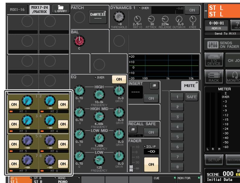
5. 送り先の MATRIX バスに対応する TO MATRIX SEND ON/OFF ボタンがオンになっていることを確認します。
