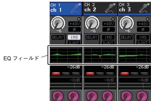
2. ATT/HPF/EQ のパラメーターの値を確認しながら変更したい場合は、OVERVIEW 画面の EQ フィールドを押して、HPF/EQ ポップアップ画面を表示させます。
