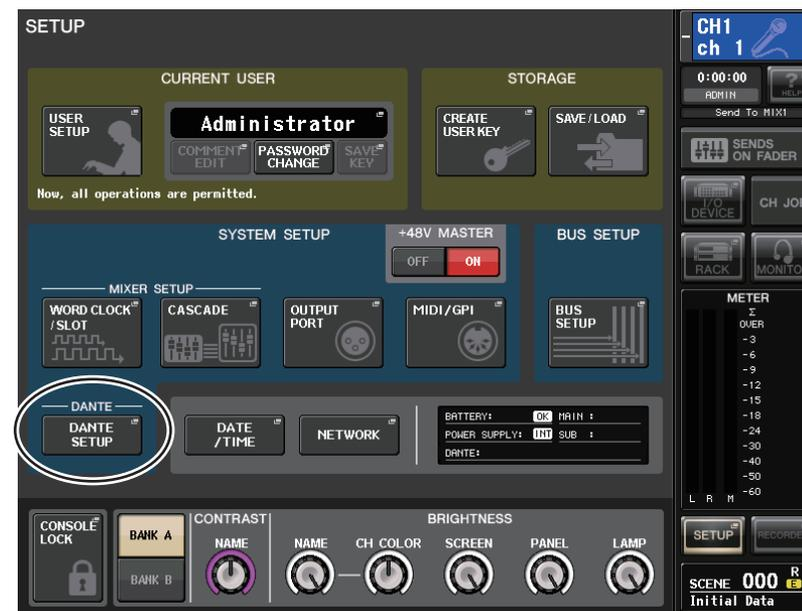
2. 画面中央の DANTE フィールドにある DANTE SETUP ボタンを押して、DANTE SETUP ポップアップ画面を表示させます。
