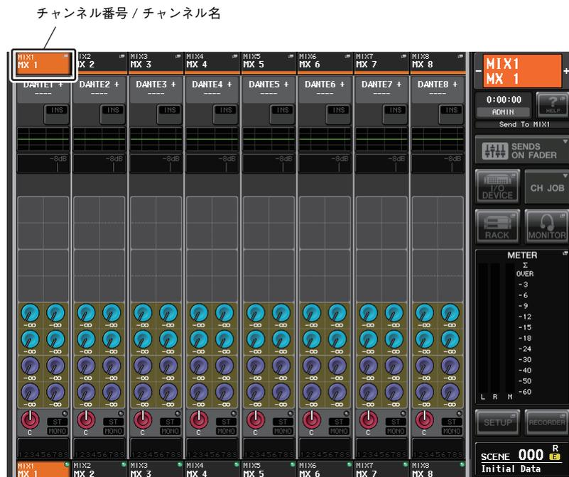
2. 画面最上部のチャンネル番号 / チャンネル名のフィールドを押して、PATCH/NAME ポップアップ画面を表示させます。
