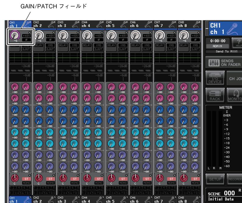
3. HAを操作したいチャンネルのGAIN/PATCHフィールドを押して、GAIN/PATCHポップアップ画面を表示させます。
