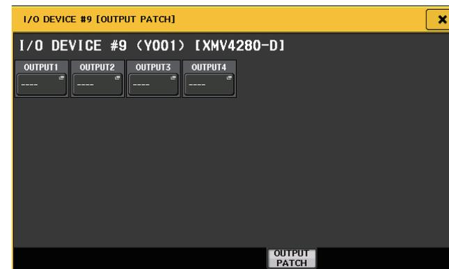
出力ポートの設定を行なう必要がある場合は、I/O デバイスのパッチの手順 7 (→ P.140) 以降と同様に設定をします。
