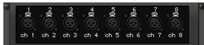
任意のインプットチャンネルの [SEL] キーを押すと、対応するポートが点灯します。
