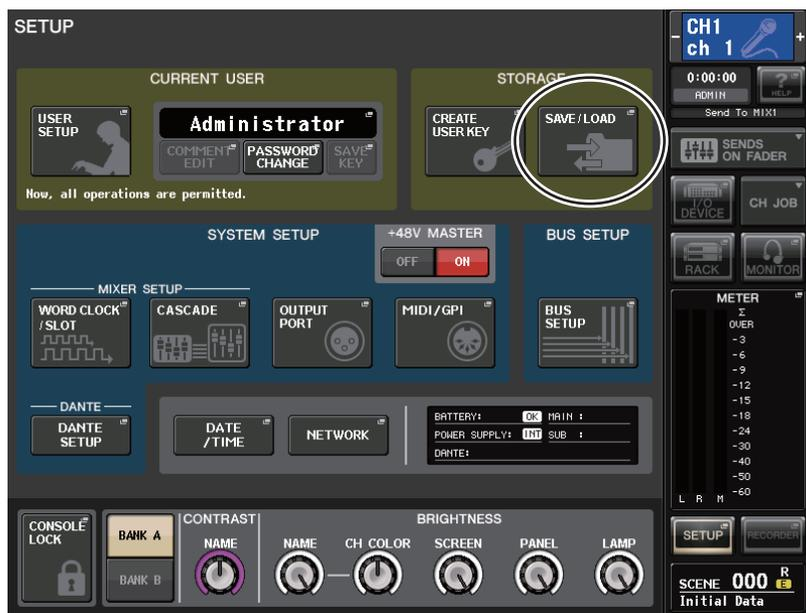
2. SAVE/LOAD ボタンを押して、SAVE/LOAD ポップアップ画面を表示させます。
