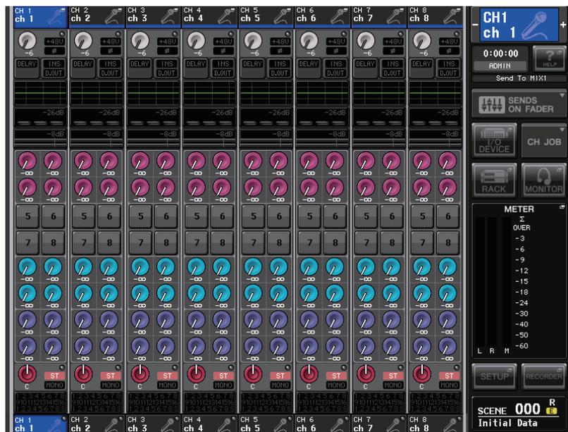
3. 送り先の MIX/MATRIX バスに対応する TO MIX/MATRIX SEND LEVEL ノブを押します。
