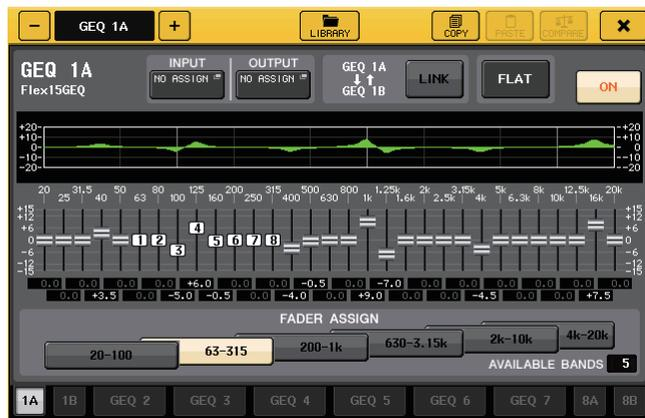
画面は31バンドGEQと同じですが、「AVAILABLE BANDS」には、現在のGEQで操作できる残りのバンド数(最大15)がリアルタイムに表示されます。
