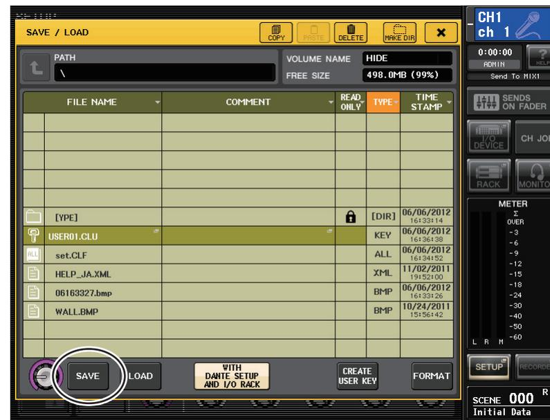
3. 必要ならば、ディレクトリーのアイコンを押して、ディレクトリーを移動します。一つ上の階層に移動する場合は、PATH フィールドにある矢印ボタンを押します。
