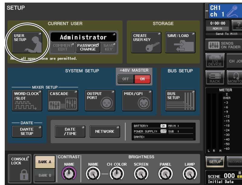
3. 画面左上のUSER SETUPボタンを押して、USER SETUPポップアップ画面を表示させます。
