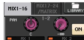
MONO チャンネルでは、右側のノブで 2 系統の MIX/MATRIX バスに共通のセンドレベル、左側のノブで 2 系統の MIX/MATRIX バス間の定位を設定します。左側の TO MIX/MATRIX SEND PAN ノブを左に回すほど奇数番号の MIX/MATRIX バスに送る信号の量が増えます。
