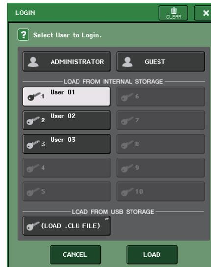
3. LOAD FROM INTERNAL STORAGE フィールドからログインしたいユーザーのユーザー認証キーを選択して LOAD ボタンを押します。
