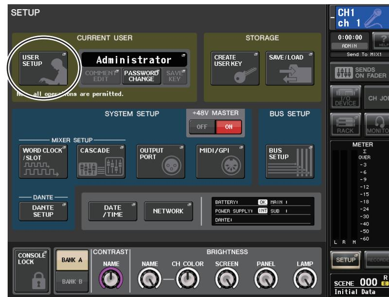
2. 画面左上のUSER SETUPボタンを押して、USER SETUPポップアップ画面を表示させます。
