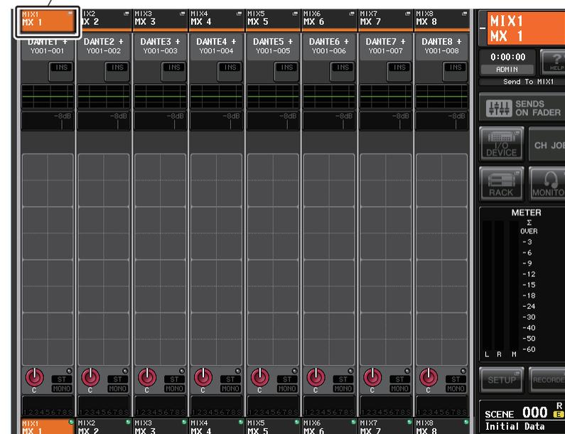
2. チャンネル名/アイコン/チャンネルカラーを設定したいチャンネルのチャンネル番号/チャンネル名フィールドを押して、PATCH/NAME ポップアップ画面を表示させます。
