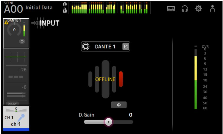
Wenn die Eingangsquelle auf DANTE eingestellt ist, wird beim Auftreten eines Fehlers ERROR angezeigt.
