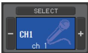
Hier werden Nummer und Name des Kanals angezeigt, auf den Ihre Bedienvorgänge angewendet werden. Um den Kanal zu wechseln, können Sie entweder auf die Schaltfläche [SELECT] (Auswahl) klicken und aus der daraufhin erscheinenden Liste einen Kanal auswählen, oder Sie können auf die Plus-/Minus-Kanalauswahlschaltflächen links oder rechts des Symbols klicken. Sie können auch das Kanalnamen-Textfeld verwenden, um den Namen zu bearbeiten.
