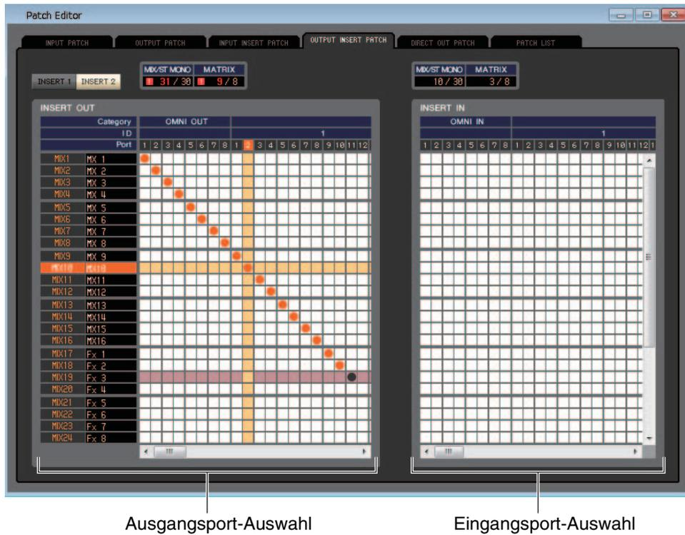
Hier können Sie die Ein-/Ausgangsporte auswählen, die dem Insert-Ein-/Ausgang jedes Ausgangskanals zugewiesen sind. Wählen Sie auf der linken Bildschirmseite den Ausgangsport und auf der rechten Seite den Eingangsport aus.
