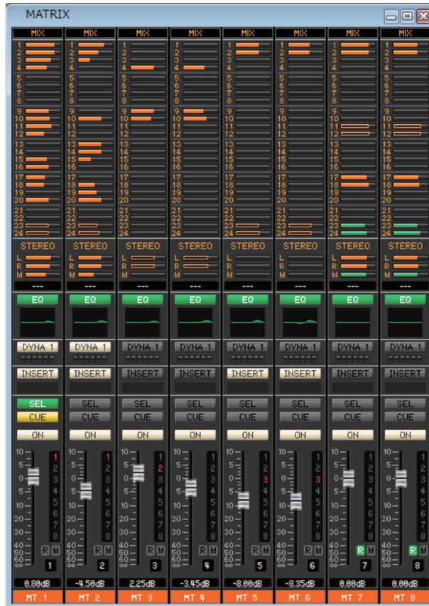
In diesem Fenster können Sie die Parameter der MATRIX-Kanäle 1–8 sehen und einstellen. Die im Fenster angezeigten Parameter können im [View]-Menü (Ansicht) oder in dem Menü ausgewählt werden, das erscheint, wenn Sie mit der rechten Maustaste (<Strg>-Taste + Klick) in das Fenster klicken.
