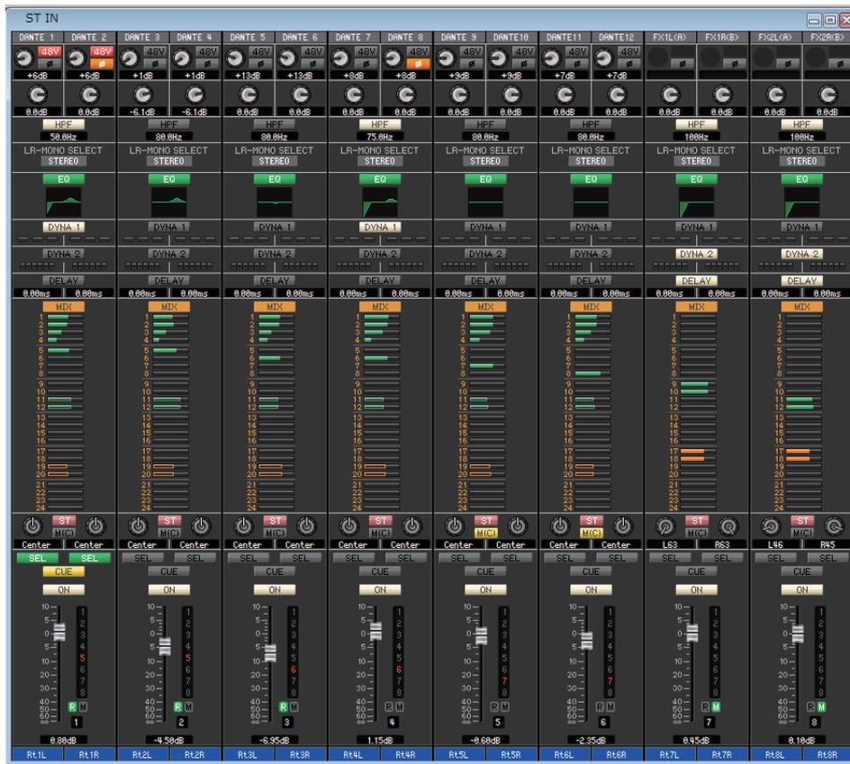
In diesem Fenster können Sie die Mischparameter der ST-IN-Kanäle 1–8 sehen und einstellen. Die im Fenster angezeigten Parameter können im [View]-Menü (Ansicht) oder in dem Menü ausgewählt werden, das erscheint, wenn Sie mit der rechten Maustaste (<Strg>-Taste + Klick) in das Fenster klicken.
