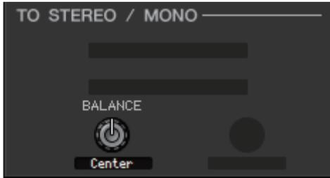
Diese Funktion wird nur angezeigt, wenn der ausgewählte MATRIX-Bus in stereo verwendet wird. Sie regelt das Links/Rechts-Lautstärkeverhältnis der Stereosignale. Sie können hier den Mittenwert einstellen, indem Sie die <Strg>(<⌘>)-Taste auf der Computertastatur gedrückt halten und auf diesen Drehregler klicken.
