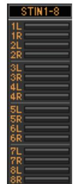
Die Balken unmittelbar unterhalb der Schaltfläche zeigen den Send-Pegel der von den einzelnen INPUT CH an die MIX/MATRIX-Busse gesendeten Signale an und stellen diese ein. Die Art der Bedienung und die Bedeutung der Anzeigen sind die gleichen wie bei (⑤) MATRIX im MIX-Fenster (➔ S. 24).
