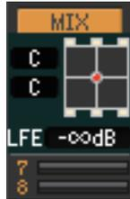
Im Surround-Modus (→ S. 3) wechselt die Send-Anzeige der MIX-Busse 1–6 zur Anzeige der Surround-Panoramaposition und des LFE-Pegels. Mit einem Doppelklick irgendwo auf die Surround-Modusanzeige können Sie das Selected-Channel-Fenster für den entsprechenden Kanal öffnen.
