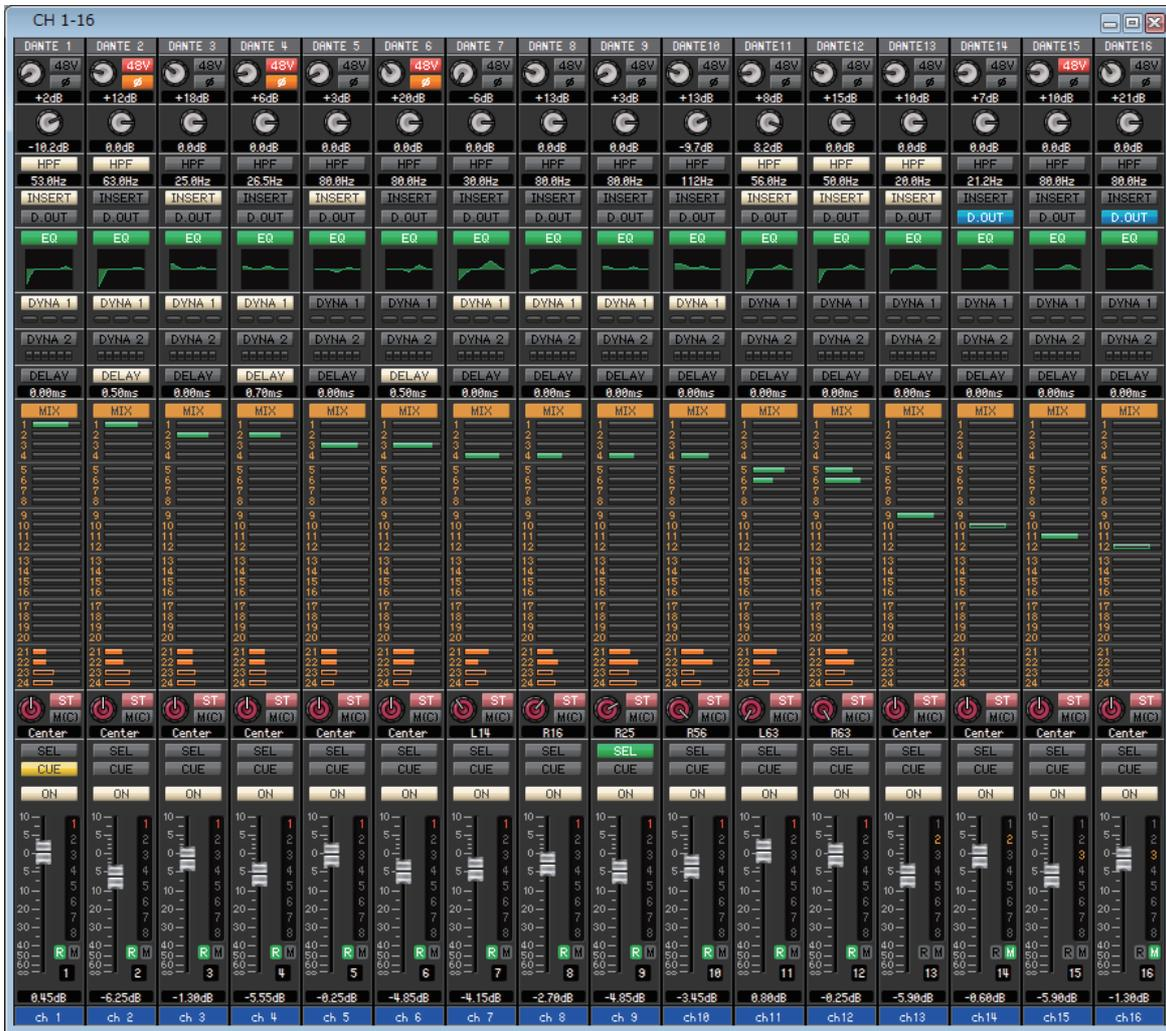
Dieses Fenster zeigt die Mix-Parameter von INPUT CH 1–16, 17–32, 33–48, 49–64 (nur CL3/CL5) oder 65–72 (nur CL5) an. Die im Fenster angezeigten Parameter können im [View]-Menü (Ansicht) oder in dem Menü ausgewählt werden, das erscheint, wenn Sie mit der rechten Maustaste (<Strg>-Taste + Klick) in das Fenster klicken.
