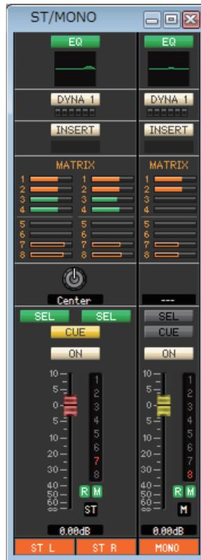
In diesem Fenster können Sie die Parameter der Kanäle STEREO und MONO sehen und einstellen. Die im Fenster angezeigten Parameter können im [View]-Menü (Ansicht) oder in dem Menü ausgewählt werden, das erscheint, wenn Sie mit der rechten Maustaste (<Strg>-Taste + Klick) in das Fenster klicken.
