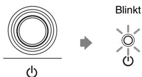
Nach einigen Sekunden leuchtet die [⏻]-Anzeige stetig schwach.
