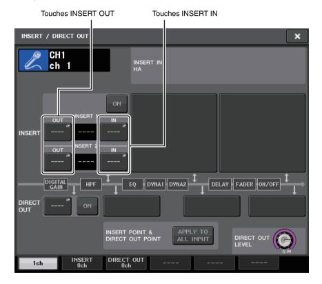
**3.** Appuyez sur la touche INSERT OUT (Sortie d'insertion) ou INSERT IN (Entrée d'insertion).
