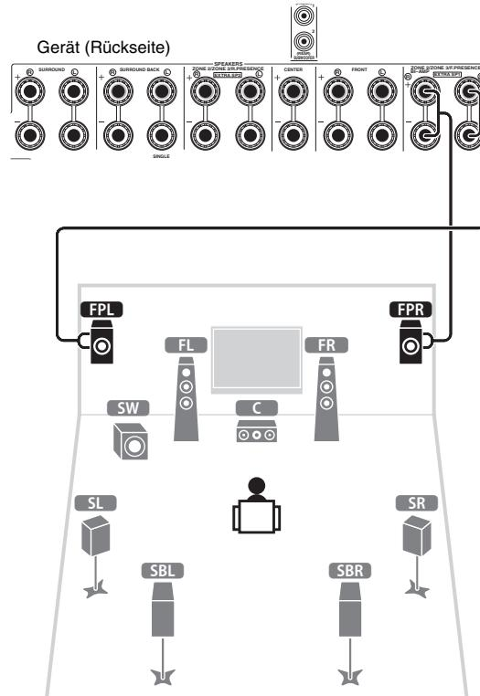
**5** Schließen Sie den Subwoofer (**SW**) an der Buchse SUBWOOFER (1) an.
