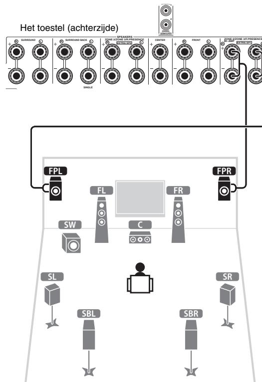
**5 Sluit de subwoofer (SW) aan op de SUBWOOFER (1)-aansluiting.**
