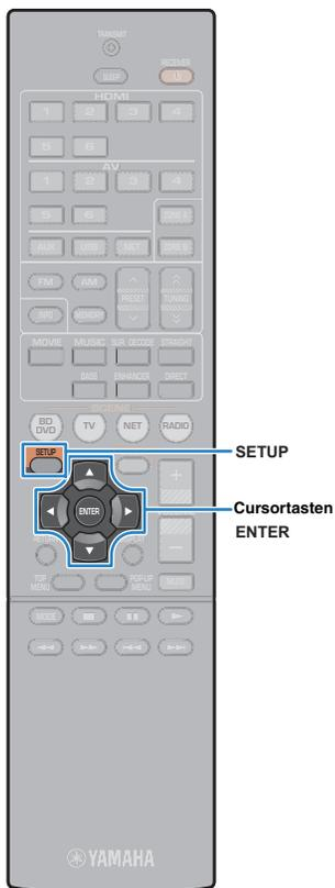
**3** Verwenden Sie die Cursortasten (Δ/∇) zur Auswahl von „Sicherheit“ und die Cursortasten (◀/▶) zur Auswahl der Verschlüsselungsmethode.
