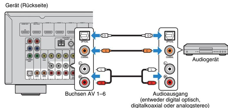
Wenn Sie die Eingangsquelle durch Drücken von AV 1-6 auswählen, werden die am Audiogerät abgespielten Audiosignale am Gerät ausgegeben.
