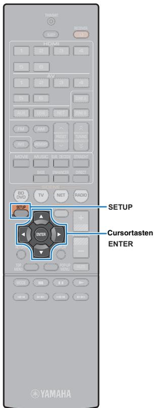
**4 Verwenden Sie die Cursortasten (Δ/▽) zur Auswahl von „Verbinden“, und drücken Sie ENTER, um mit dem Verbindungsaufbau zu beginnen.**
