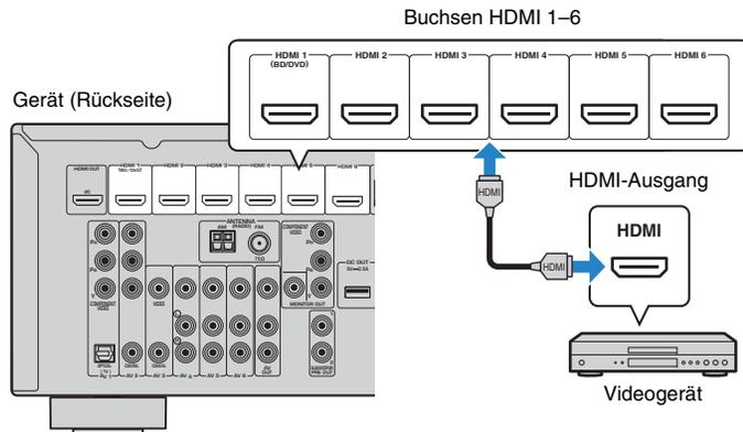
Wenn Sie die Eingangsquelle durch Drücken von HDMI 1–6 auswählen, werden die am Videogerät abgespielten Video-/Audiosignale vom Gerät ausgegeben.
