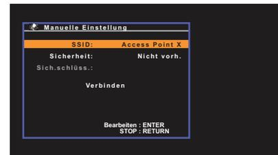
**1 Verwenden Sie die Cursortasten (Δ/▽) zur Auswahl von „SSID“, und drücken Sie ENTER.**
