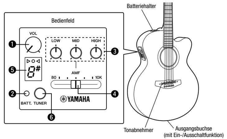
Der eingebaute Vorverstärker wird automatisch eingeschaltet, wenn Sie ein Kabel an die Ausgangsbuchse anschließen. Das Stimmgerät kann jederzeit ein- und ausgeschaltet werden.
