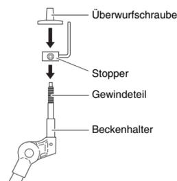
5. Ziehen Sie, während wie unten gezeigt der Stopper vollständigen Kontakt mit der Unterseite der Überwurfschraube hat, den Keilbolzen des Stoppers mit dem Stimmschlüssel fest.
