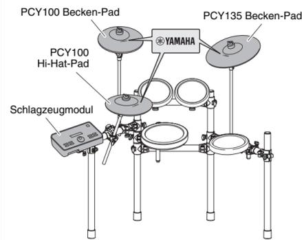
Der eingebaute Sensor eines Becken-Pads befindet sich in Nähe des Yamaha-Logos auf der Oberseite. Um die beste Leistung aus Ihrem Pad herauszuholen, positionieren Sie es so, dass der Bereich in Nähe des Logos einfach angeschlagen werden kann. (Siehe Abbildung oben.)
