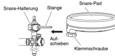
3. Lösen Sie die Klemmschrauben A bis D, wie unten gezeigt, um die Höhe und den Winkel der Spielfläche des Snare-Pads einzustellen. Sobald die richtige Position gefunden ist, ziehen Sie die Schrauben wieder gut fest, bevor Sie mit dem nächsten Schritt fortfahren.
