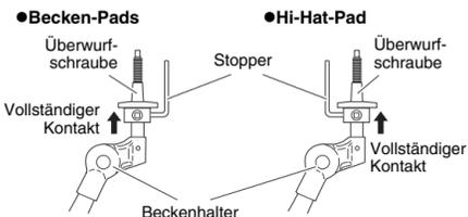
6. Stecken Sie eine der in Schritt 2 entfernten Filzscheiben auf den Beckenhalter.
