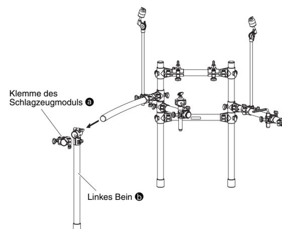
2. Montieren Sie die Halteklemme für die Hi-Hat-Halterung, und achten Sie dabei darauf, dass sie so wie in der Abbildung gezeigt ausgerichtet ist. Montieren Sie dann erneut das linke Bein **b** und die Drum-Trigger-Modul-Klemme **a**.
