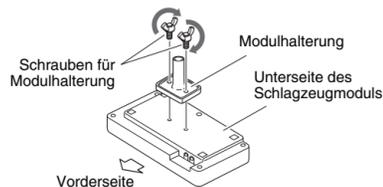
2. Stecken Sie die Modulhalterung in die Halteklemme und ziehen Sie die Klemmschraube fest, um die Modulhalterung in ihrer Position zu fixieren.
